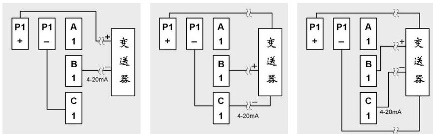
两线制变送器接线图
