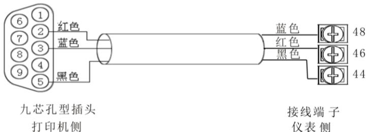
图 2-2-6-B 打印机与仪表间的 RS-232C 通讯线
