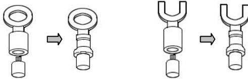
用绝缘套筒压接线端子（4mm 螺钉用）
