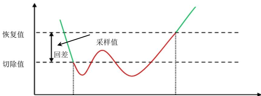
红色区域为小信号切除区、绿色区域为正常采集区。当测量值小于切除值时,执行小信号切除处理,当测量值大于恢复值,或连续 20 次采样值均大于切除值时,取消小信号切除处理,恢复正常测量。
