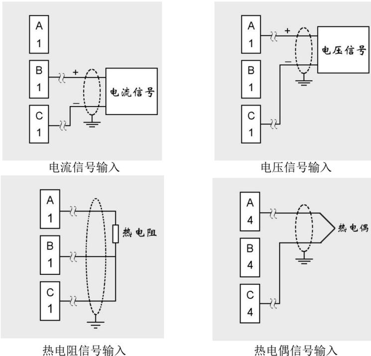
图 2-2-4 模拟量输入信号接线图
